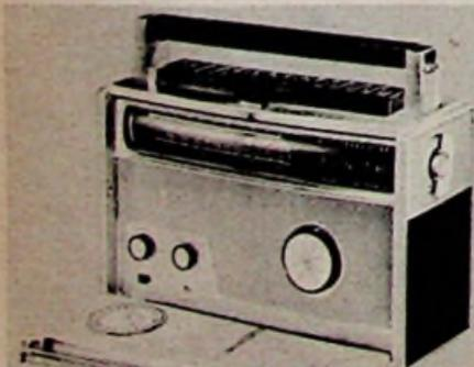
Zenith-Trans-Oceanic, ein Alltransistor-Reiseempfänger mit UKW-Bandspreizung
